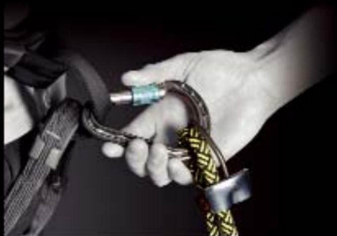
✓ Fermeture du mousqueton à verrouillage
