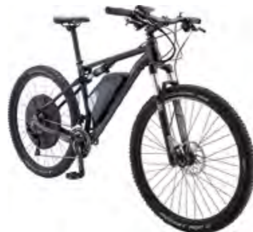
Wheeler E-Falcon – Système Bionx – Le plus démultiplié (trois plateaux)
